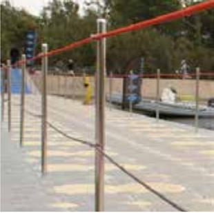
Fijación con retranqueo de 50cm, en la intersección de 4 cubos. Distancia entre postes 2 a 3 metros. Están conectados por cabos rojos, naranjas o azules / blancas / rojas de 16 mm con o sin red (se venden por separado). Dimensiones (Ø x Al): 4,2 x 110 cm / Peso: 4,00 kg
